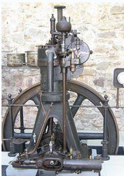
Стационарный одноцилиндровый дизельный двигатель, Германия , Аугсбург , 1906
